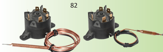
Трехполюсный термостат высокого предела с ручным сбросом, отказоустойчивый, фиксированная настройка, диапазон температур до 170°C
